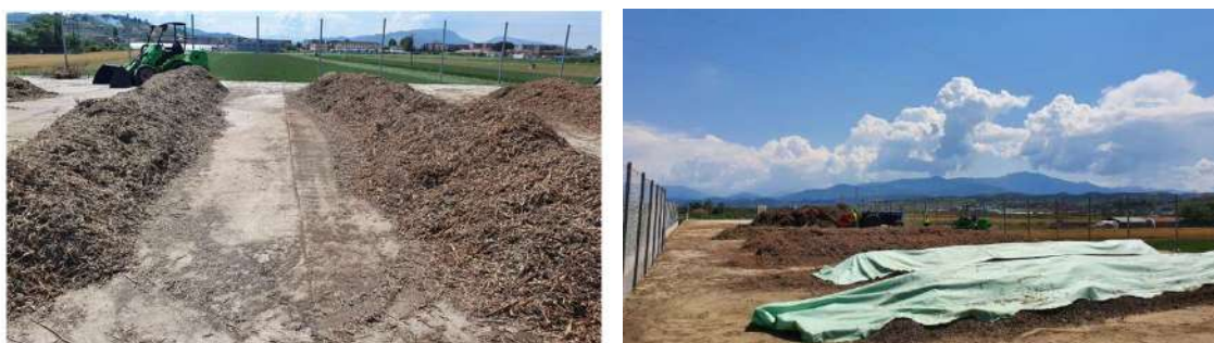
Figura 27. Një impiant tipik kompostimi i vargjeve
